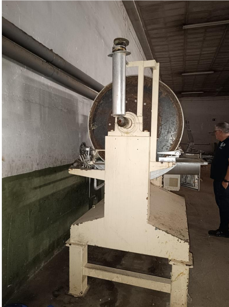
Vista frontal do tambor de incrustação, você pode ver a bandeja aplicadora de produtos líquidos na frente e o painel de controle elétrico no lado direito:
